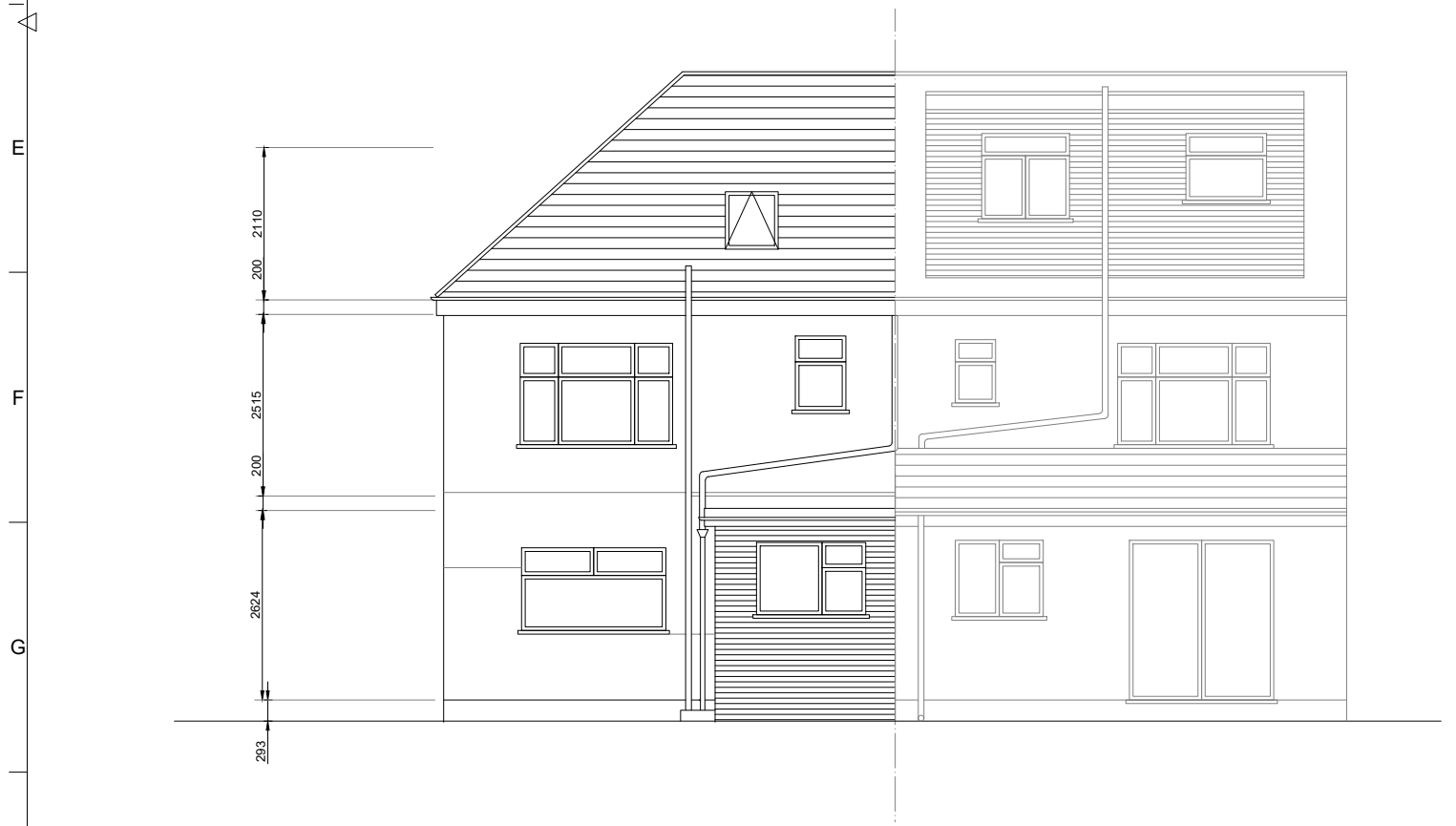
3 REAR ELEVATION - EXISTING Scale: 1:100
