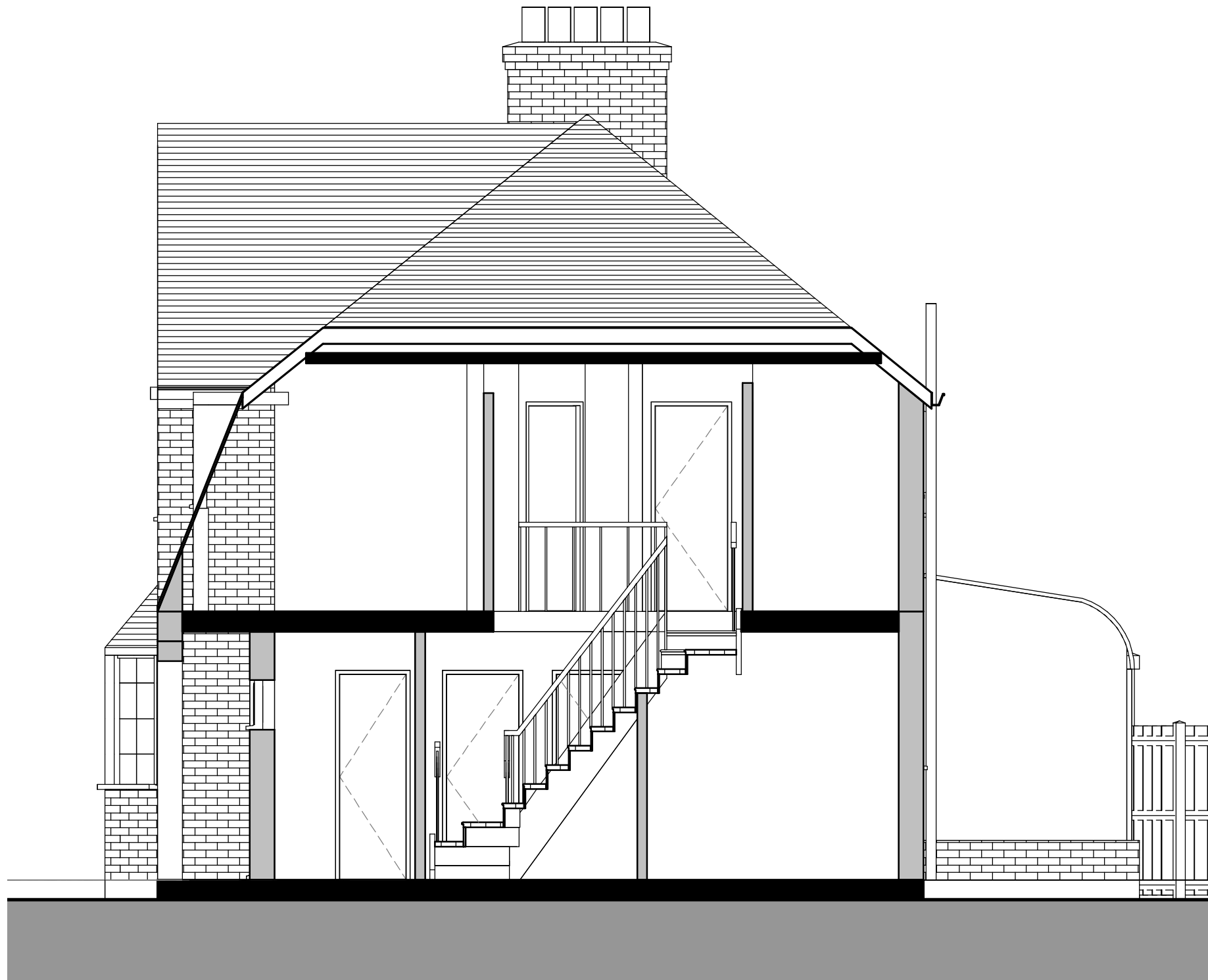
Existing Section A-A 1 : 50
